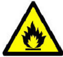
RIESGO DE INCENDIO
