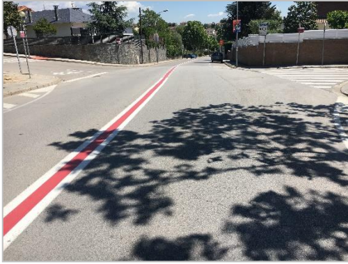
Imatge 34. Exemple d'estrenyiment d'amplada de la calçada pintant doble línia continua amb espai al mig.
